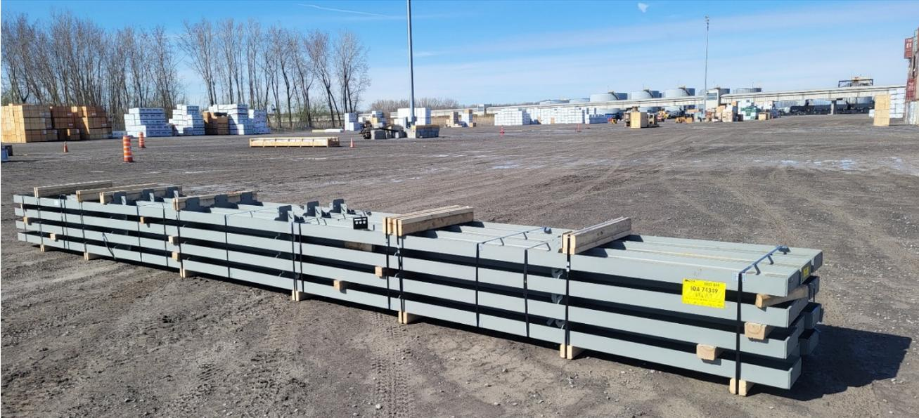
1. Chaque assemblage de pièces d'acier doit avoir des blocs de 4" rainurés répartis uniformément sur sa longueur et les sangles d'acier retenant ceux-ci doivent avoir une largeur d'au moins  $\frac{3}{4}$ ". Les blocs doivent légèrement excéder la largeur du paquet.
