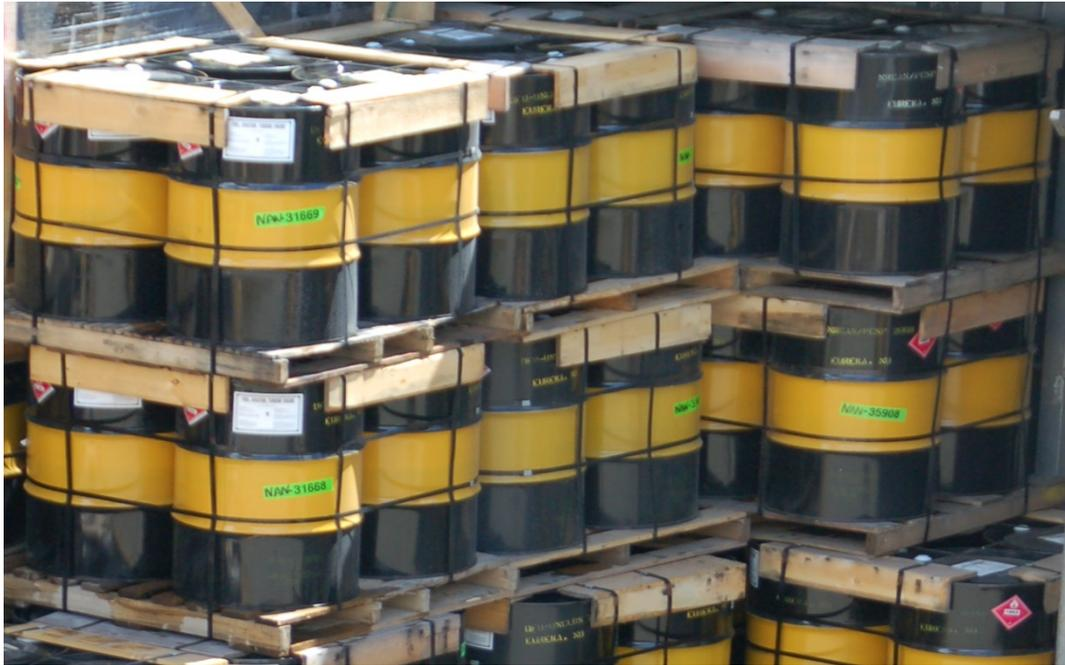
1. Un minimum de quatre sangles d'acier doit être installé sur chaque palette. Cela comprend deux ou quatre sangles verticales placées sur des barils maintenus avec des coins de bois ou un couvercle en contre-plaqué d'une épaisseur suffisante, ainsi que deux sangles horizontales passant sous les sangles verticales entourant les barils.
