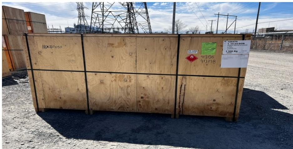
1. Les caissons fermés doivent être étanches et le contenu enveloppé d'une pellicule en polyéthylène d'une épaisseur adéquate, le protégeant d'une infiltration d'eau.
