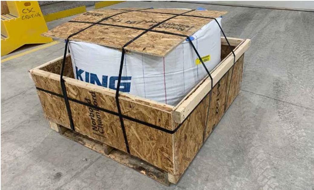
1. Une palette de bois franc solide est requise pour supporter le poids de la cargaison. Celle-ci doit être de dimensions légèrement supérieures à celles du sac. Les planches transversales doivent être très peu espacées ou être recouvertes d'un contre-plaqué.
