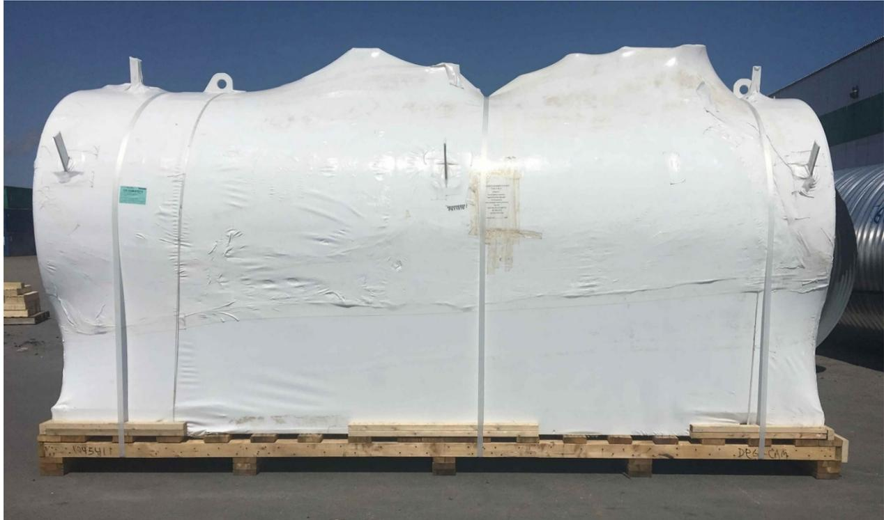
1. Les réservoirs de grande dimension doivent être sécurisés sur une base excédant légèrement les dimensions de ceux-ci. Un espacement de 6" sous la base est requis pour en faciliter la manutention.
