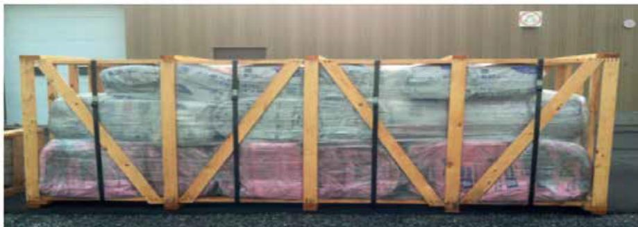
Des patins de 4" x 4" sont nécessaires sous le caisson pour permettre toute manutention au chariot élévateur. Ils devraient être fixés solidement (vis/clous et sangles d'acier), couvrir la largeur complète du caisson et placés à des intervalles de 4'.
