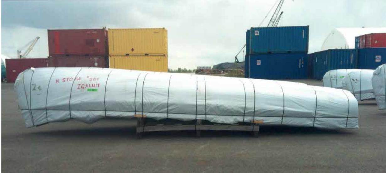
1. Les canoës et les bateaux doivent être sécurisés sur une base de grandeur adéquate avec des blocs de 6".
