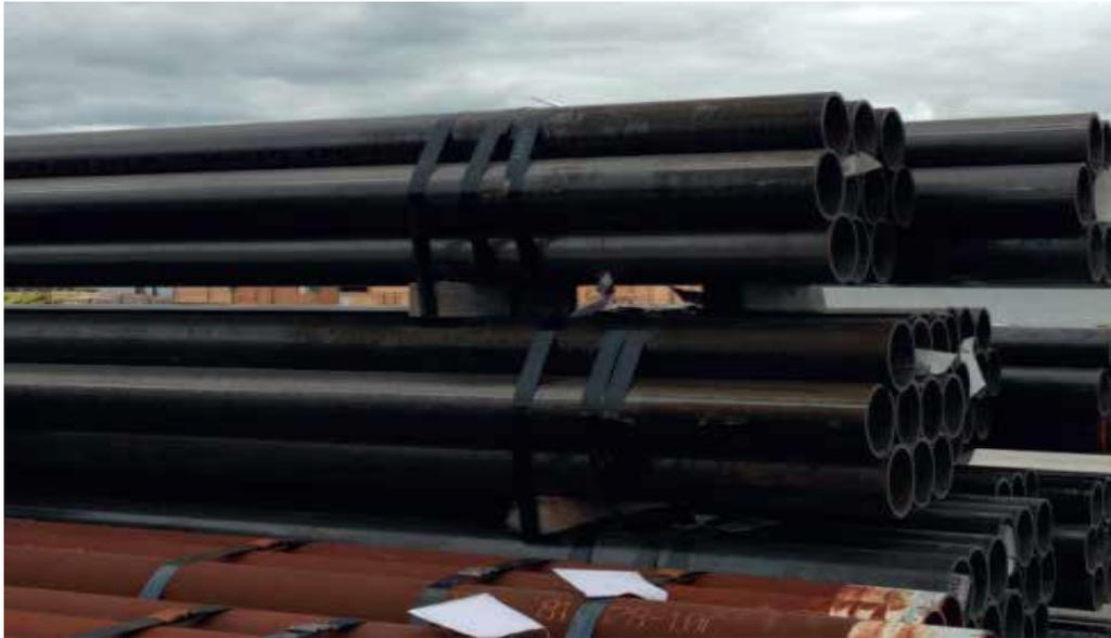
1. Chaque assemblage de tuyaux doit avoir des blocs de 4" rainurés répartis uniformément sur sa longueur et les sangles d'acier retenant ceux-ci doivent avoir une largeur d'au moins  $\frac{3}{4}$ ". Les blocs doivent couvrir la largeur du paquet afin d'en assurer la stabilité.
