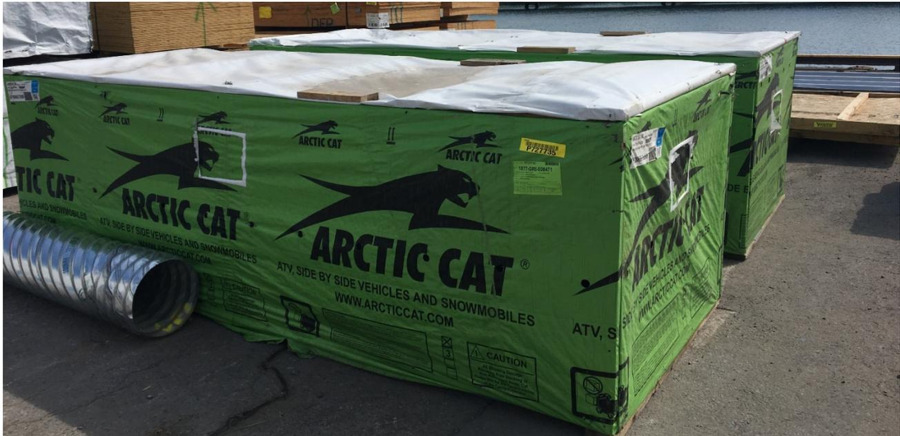
1. Si l'emballage du fabricant est conservé, l'ajout de blocs permettant de créer un espacement de 4", facilitant la manutention, est exigé. De plus, une feuille de contre-plaqué doit être fixée sur le dessus du produit.
